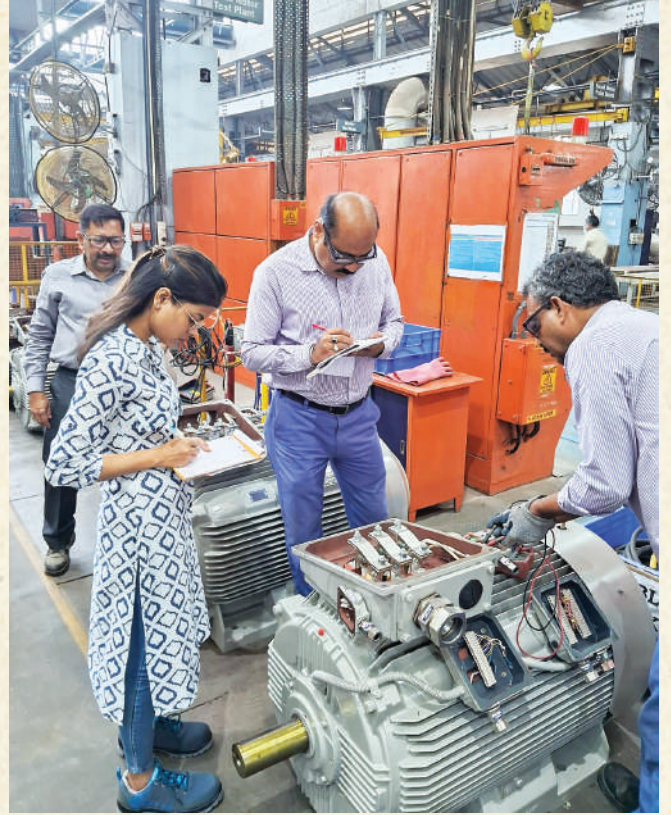
एनएमडीसी स्लरी पाइपलाइन परियोजना के लिए कोलकाता स्थित मैराथन वर्क्स में एलटी मोटर (IT Motors) का निरीक्षण।
